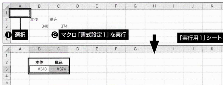
図5 作成されたマクロ「書式設定1」の実行結果を確認しよう。「実行用1」シートを表示し、任意のセル(ここではA1セル)を選択した状態で、「表示」タブの「マクロ」からマクロ「書式設定1」を実行する。このシートのB2~C3セルに、記録時と同じ書式が自動的に設定される
