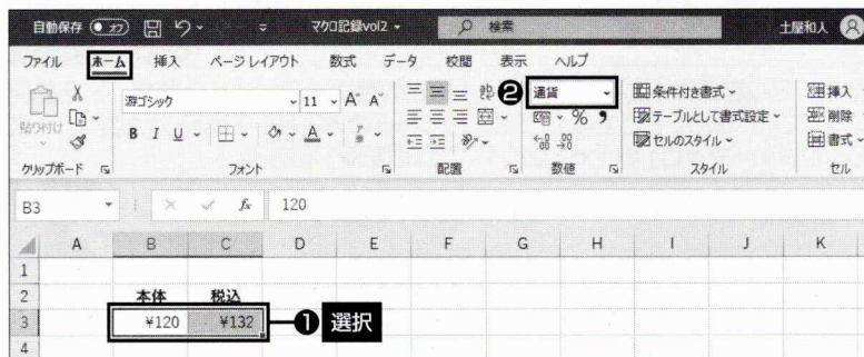
図4 B3~C3セルを選択し、「ホーム」タブの「数値の書式」の「▼」から「通貨」を選ぶ。これで、この2つのセルの数値が、「¥」の付いた通貨形式で表示される。記録したい操作はこれだけなので、「表示」タブの「マクロ」からマクロの記録を終了する
