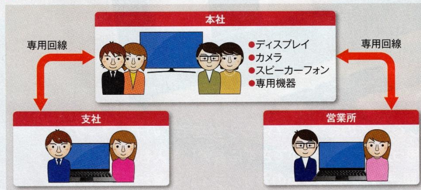
図3 専用の機器を使うテレビ会議システムは、音声や映像を安定して送受信できる反面、小規模オフィスや個人での導入は難しい
